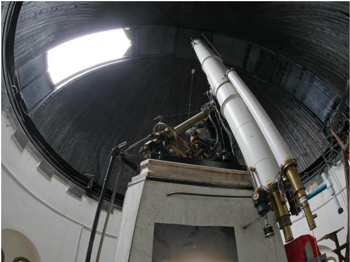
30cm-Refraktor, Alvan Clark & Sons, 1873 Durchmesser des Objektivs: 30 cm, Brennweite: 5,06 m Signatur am okkularseitigen Ende: Clark, Massachusetts Tubus und Montierung vermutlich nicht von Clark Aus der Westkuppel der Universitätssternwarte Wien
