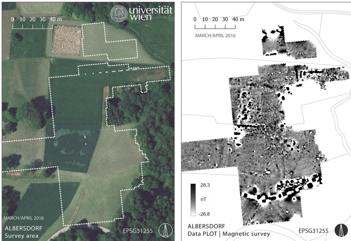
Abb. 7: Albersdorf, Bereich der 2016 erfolgten Magnetikmessungen (links) und dessen Ergebnisse im Magnetogramm (rechts), wo im nördlichen Abschnitt die orthogonalen Mauerfluchten deutlich zu erkennen sind. (Plan: Alarich Langendorf 2017, [CC BY 4.0]; Basisdaten: Land Oberösterreich 2014 [CC-BY 3.0 AT], Bundesamt für Eich- und Vermessungswesen 2017 [CC-BY-SA 2.0])
