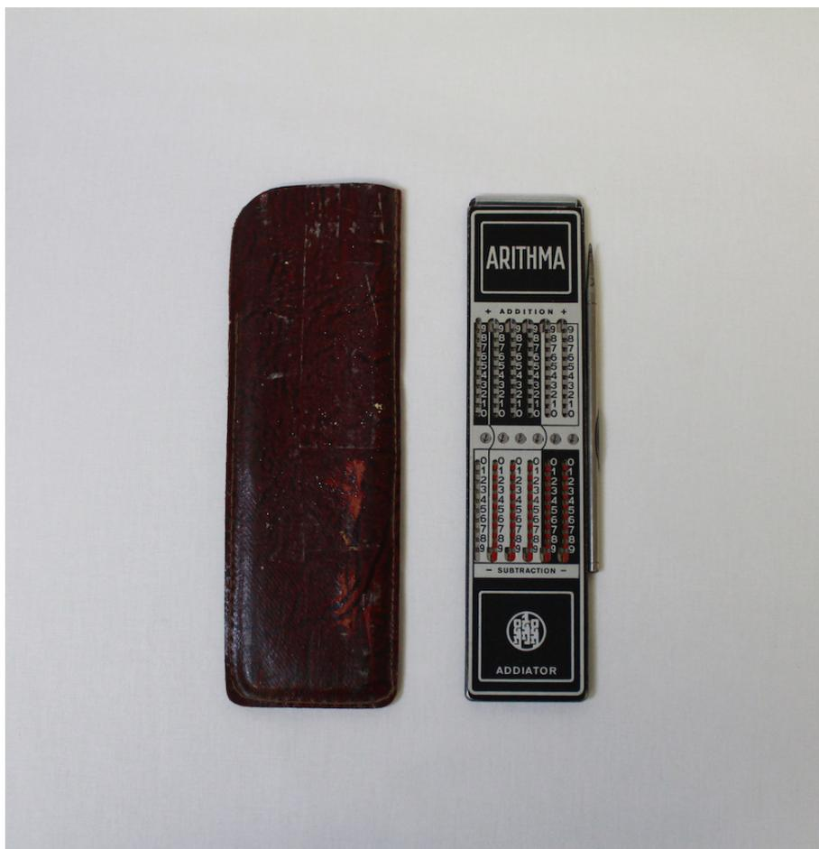
Abb. 9: „Arithma-Kleinrechenmaschine Addiator“, 16 x 4 x 0,4 cm Sig.: 1-11,
