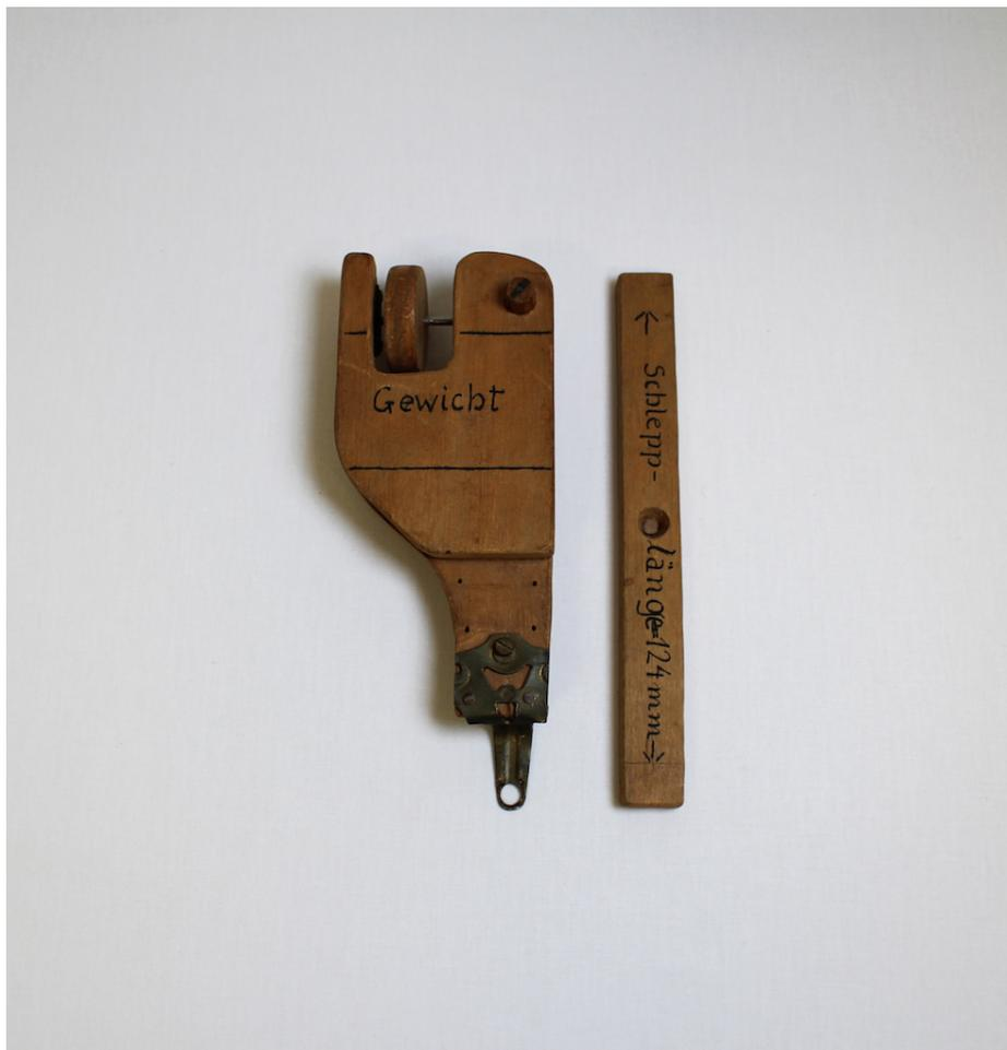
Abb. 19: Zeichengerät mit Rolle, Bleistift und Schlepplänge, Holzstange: 15,5x1,7x1 Wagen: 14,5x5,6x4, cm, Sig.: 3-5,
