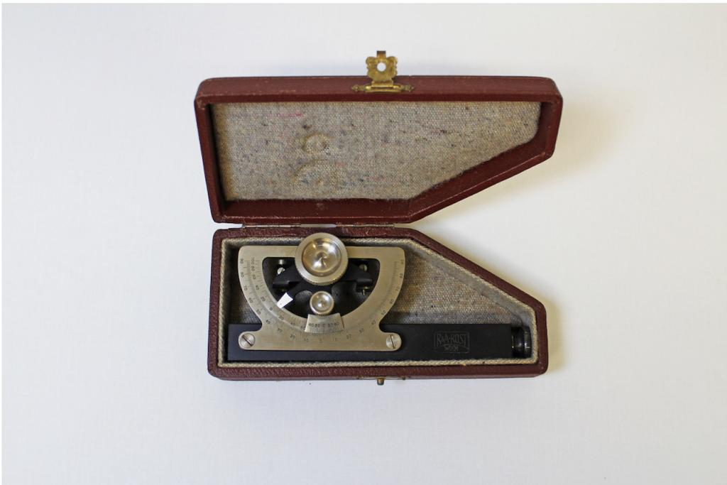
Abb. 25: Taschenwinkelmessgerät „R&A Rost Wien“, 12,6 x 5,5 x 5,4 cm, Sig.: 4-6,
