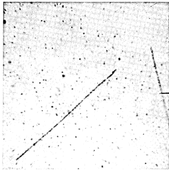
Bahnspur eines Alphastrahls in einer photographischen Emulsion
