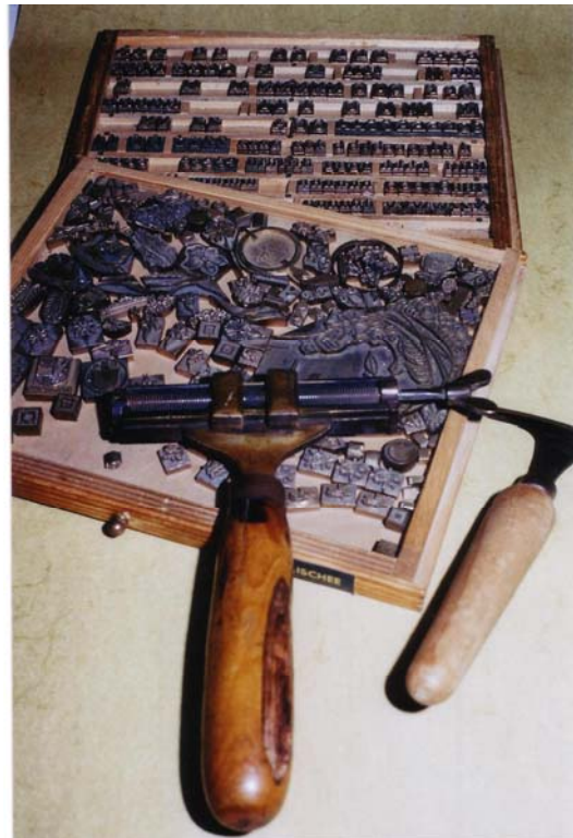
Abb. 96: Lade mit Messinglettern und Lade mit Prägeklischees, davor Zentralschriftkasten und Filete. Foto mit freundlicher Genehmigung der Buchbinderei Gerhard Wursag, 1090 Wien (Foto 2/2008).
