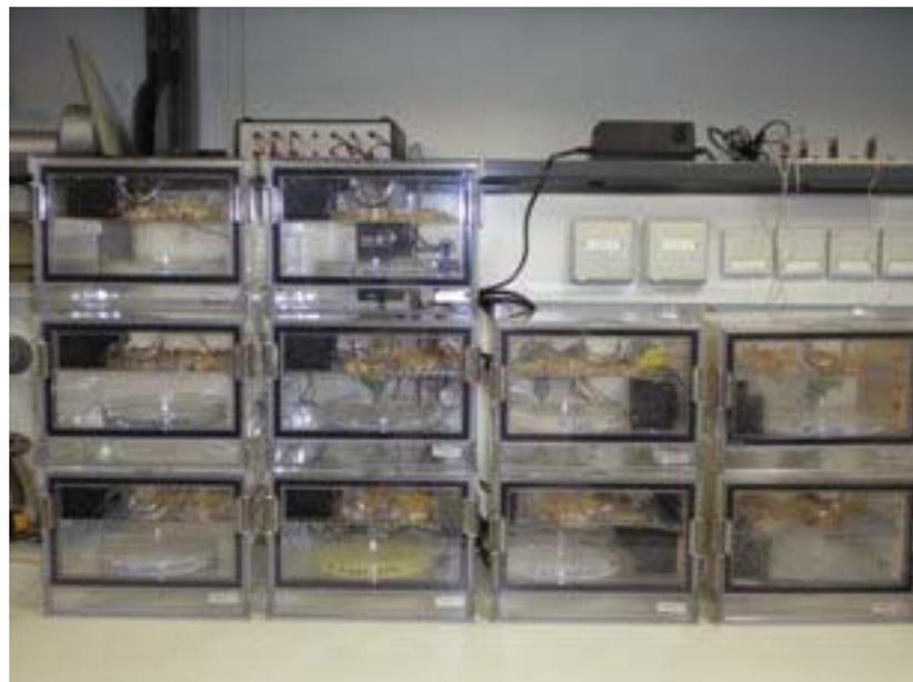
*Abb. 4.6: Klimakammern mit Salzlösungen und Proben*
