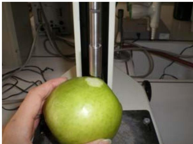
*Abb. 4.3: Messung der Fruchtfleischfestigkeit mit Penetrometer*
