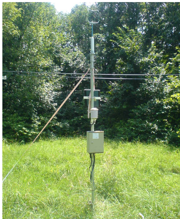
Abbildung 2: Obenstehende Abbildung zeigt die behandelte Messanordnung mit dem WindMaster Ultraschallanemometer (ganz oben auf dem Masten), sowie den im Strahlungsschutz untergebrachten Temperatursensor. Im Schaltschrank befinden sich der Datalogger und das GSM Modem
