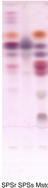
Abb. 24: DC Hydrolysat reduziertes SPS (SPSr); SPS nach Smith-Abbau (SPSs); Mischstandard (Mstd)
