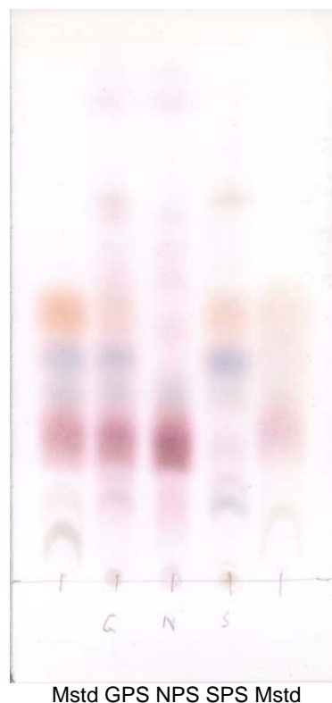
Abb. 2: Hydrolyse der drei Polysaccharidfraktionen (GPS NPS, SPS) mit 2M TFA 2Std. 120 °C, 1x entwickelt, manuell aufgetragen
