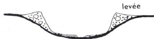
Abbildung 7 : Querschnitt einer Murbahn mit abgelagerten Levees (aus KERSCHNER 1999, S.79).
