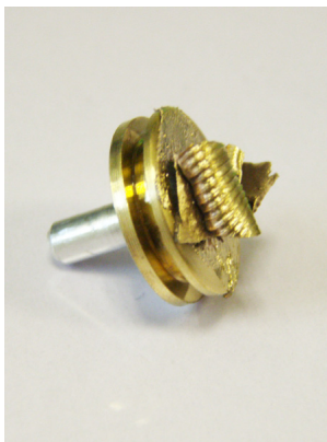
Abbildung 86: Goldbeschichteter Stub mit aufgeklebter Probe
