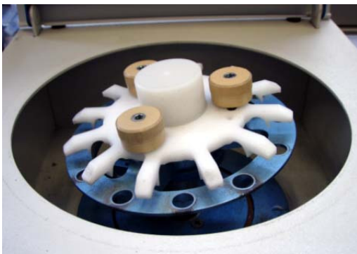
Abbildung 52: Bead-Beater zum mechanischen Aufschluß der Zellen
