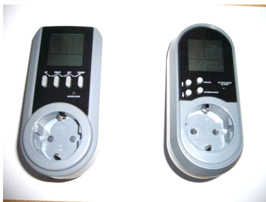
Abbildung 13: Foto Strommessgeräte Vorderseite
