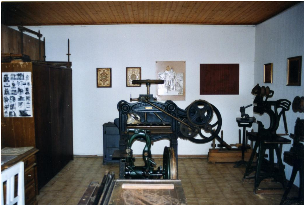
Abb.60: Ansicht der Sammlung Ferdiny im Weinlandmuseum Asparn an der Zaya, linke Hälfte: zwei Kästen und Schreibtisch, in der Mitte vorne Pappschere, dahinter motorisierter Stopper (Drahthefmaschine) und Radschneider, rechts von hinten nach vorne: Klotzpresse, Ösenmaschine, Klopfer (Drahthefmaschine mit Fußbetrieb), Stopper (Drahthefmaschine mit Fußbetrieb), an den Wänden Arbeiten von Ferdiny
