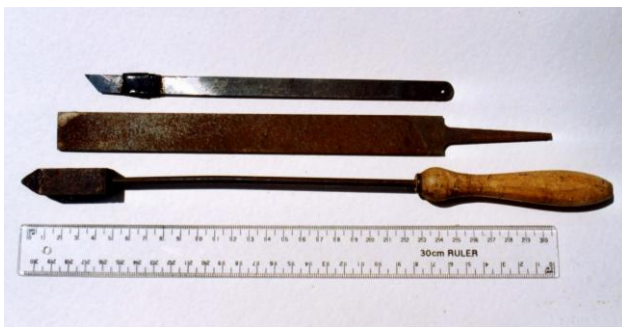
Abb.72: Werkzeug aus der Glasvitrine, links von oben nach unten: Schnitserzunge, Feile und Glättzahn, rechts von oben nach unten: durch häufigen Gebrauch abgeschliffenes Buchbindermesser, Schnitserzunge, Hohleisen (Hohlbeitel)
