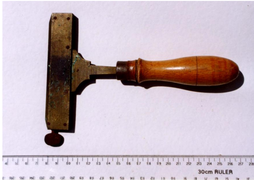
Abb.74: Handschriftkasten für Prägesatz zur Titelprägung der Lederbilder
