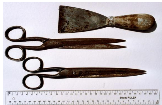
Abb.73: Werkzeug, links von oben nach unten: Stanzeisen, Streicheisen, rechts von oben nach unten: Spachtel, Scheren
