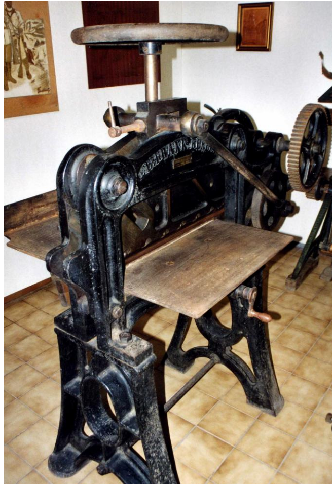
Abb.67: großer Radschneider (große Schneidemaschine), Planschneider
