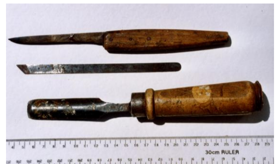
Abb.72: Werkzeug aus der Glasvitrine, links von oben nach unten: Schnitserzunge, Feile und Glättzahn, rechts von oben nach unten: durch häufigen Gebrauch abgeschliffenes Buchbindermesser, Schnitserzunge, Hohleisen (Hohlbeitel)
