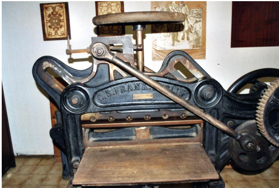
Abb.68: Großer Radschneider, von Ferdiny gebraucht übernommen, zum Schneiden von Buchblöcken und starken Kartonagen
