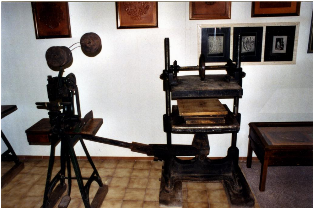
Abb.66: Stirnseite: Drahtheftmaschine (Stopper), gusseiserne Kniehebelpresse
