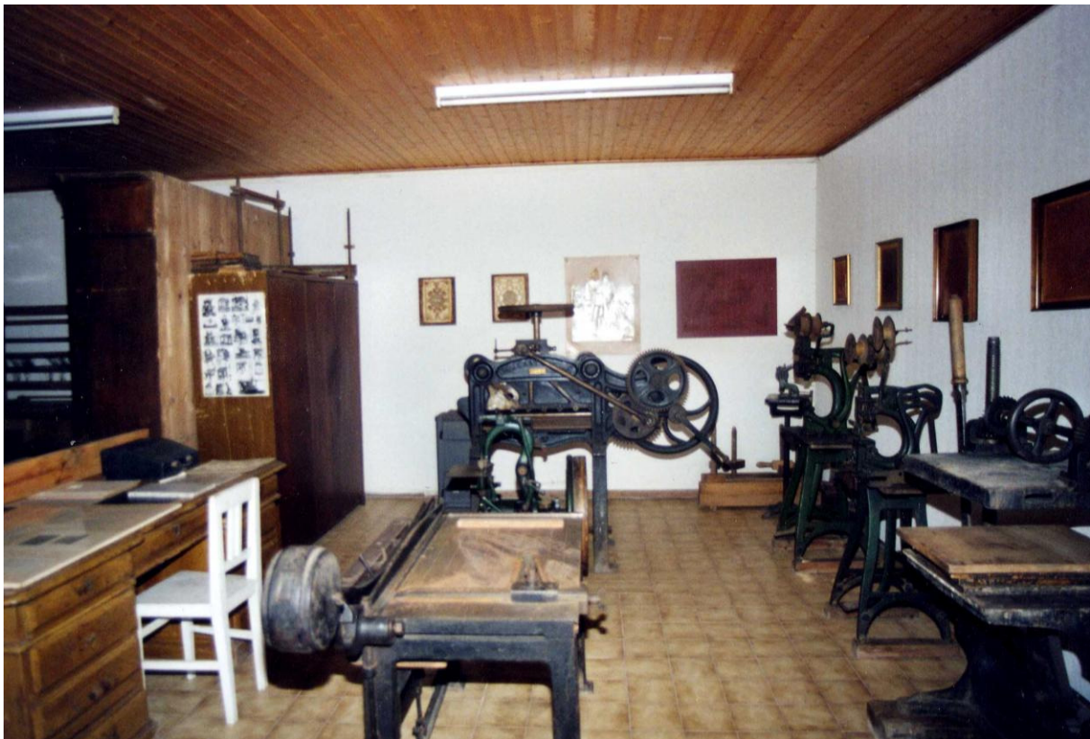
Abb.75: Links von hinten nach vorne: zwei Kästen mit Arbeitsunterlagen, Musterzeichnungen, Matrizen, Patrizen, Fotoalben etc., auf dem Kasten: zwei Heftladen, Mitte hinten: Radschneider, davor: Drahtheftmaschine (Stopper) mit Motorantrieb und Pappschere, rechts von hinten nach vorne: Klotzpresse, Ösenmaschine, Klopfer und Stopper (Drahtheftmaschinen) mit Fußantrieb, Kniehebelpresse (diese wurde zur Erzeugung der reliefartigen Lederbucheinbände im Lederpräge(press)verfahren verwendet), an den Wänden: Arbeiten Josef Ferdinys
