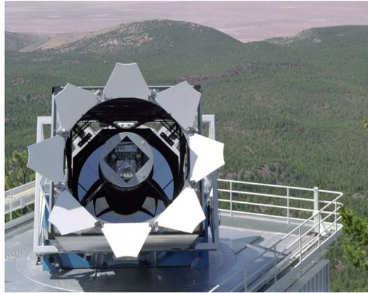
Abbildung 5.1: Das 2.5-Meter Spiegelteleskop des Apache Point Observatoriums auf 2788 m Seehöhe. (Quelle: [http://www.sdss.org/gallery/gal\\_photos.html](http://www.sdss.org/gallery/gal_photos.html))
