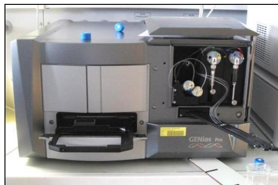
Abbildung 14: Fluorometer / Luminometer
