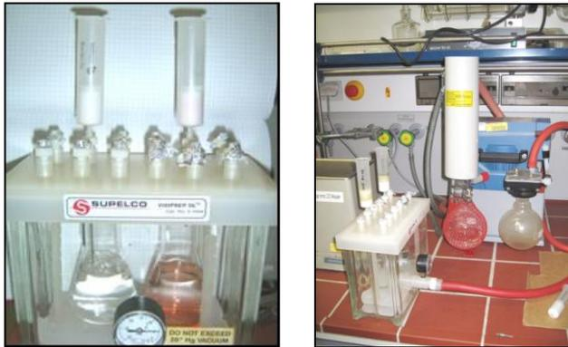
Abbildung 10: Apparativer Aufbau der Festphasenextraktion.
