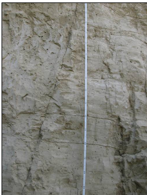
Abbildung 39: Links) Groß- und rechts) Detailaufnahme des tektonischer Risses mit einem Versatz von 2-3cm, Profil LZ 4. Quelle: Eigene Aufnahme 09/2008.
