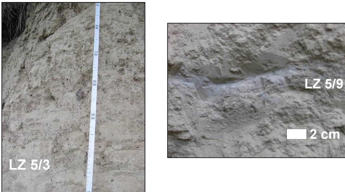
Abbildung 41: Detailaufnahme links) der homogenen Lössschicht LZ 5/3 und rechts) eines grauen Bandes LZ 5/9, Profil LZ 5. Quelle: Eigene Aufnahme 07/2008, eigene Bearbeitung.
