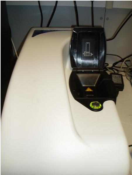
Um Mehrfachstreuungen zu vermeiden kamen Verdünnungen der Nanoemulsion von 1:100 bei den Messungen zum Einsatz. Dabei wurden 100  $\mu\text{l}$  der Probe mit 10 ml destilliertem Wasser, das unmittelbar davor frisch keimfiltriert worden war, verdünnt. Anschließend wurden die Proben unverzüglich vermessen.
