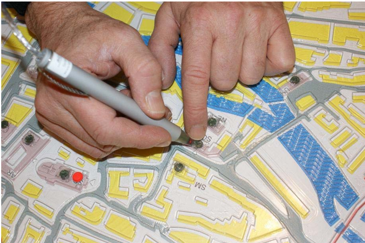
Abbildung 20: zeigt Tag It Guide im Einsatz: RFID Lesegerät in Kugelschreiberform beim Lesen eines RFID Transponder am Stadtplan Nürnberg
