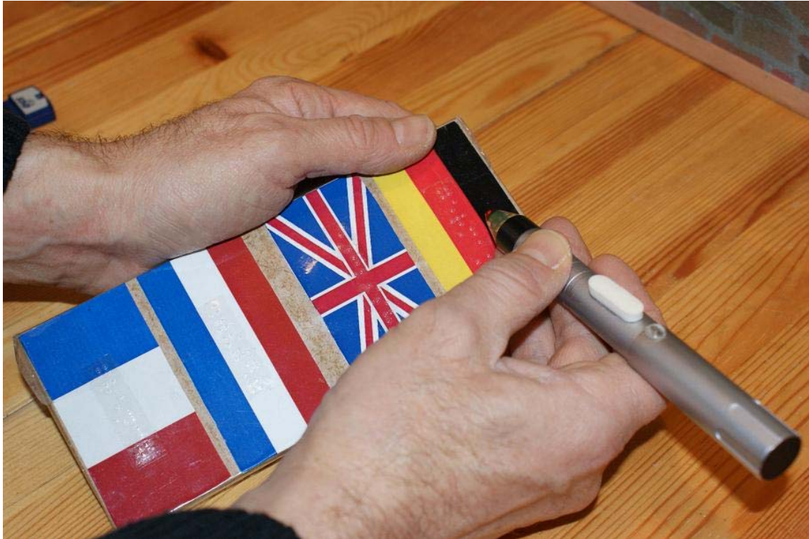
Abbildung 21: Sprachauswahl mit kabellosem RFID Lesegerät, lesen der flächenmäßig größeren RFID Transponder
