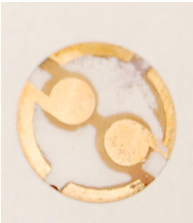
Abb. 21: Elektroden der Referenz (Luft)- phase an der Unterseite
