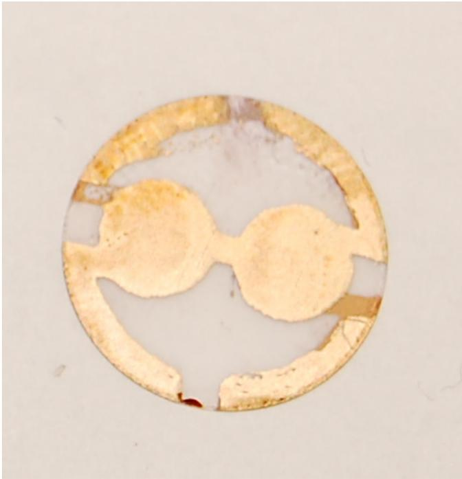
Abb. 20: Elektroden der flüssigen Phase an der Oberseite
