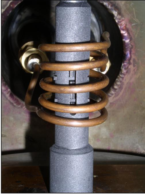
**Abbildung 12:** Arbeitsspule mit Probe in Haltevorrichtung
