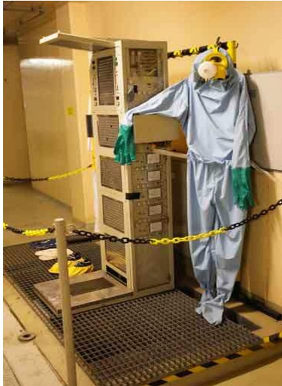
*Abbildung 6 Strahlenschutz-Anzug, dahinter ein Monitor zur Personenstrahlenmessung*
