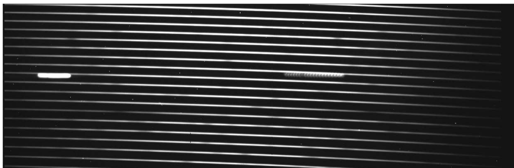
Abbildung 2.3: Echellespektrum von V1208 Aql . In vertikaler Richtung sind die einzelnen Ordnungen dargestellt, während in horizontaler Richtung der entsprechende Wellenlängenbereich dargestellt ist.
