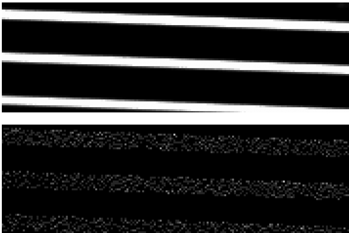
Abbildung 3.7: 8-fache Vergrößerung des Masterflat (oben) und des normalisierten Masterflat (unten). Deutlich zu erkennen ist, dass im normalisierten Masterflat außerhalb der Ordnungen alle Pixelwerte gleich sind. Diese Pixel sollen ungefähr den Werte 1 besitzen. Innerhalb der Ordnungen sind die Variationen in der Intensität zwischen den Pixeln gut zu erkennen. Ein heller Pixel wird nach der Anwendung des normalisierten Flat relativ dunkler sein, während dunkle Pixel relativ heller werden.
