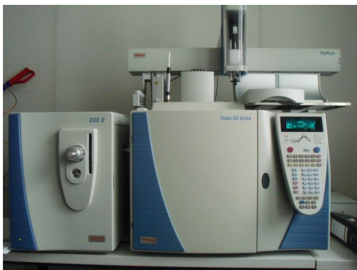
Abbildung 7 Gaschromatograph- Massenspektrometer, verwendet für die Analyse Photo: Pauzenberger [12].
