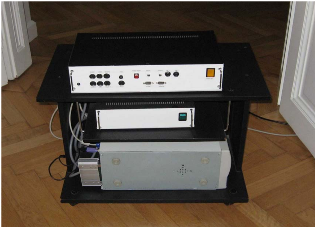
Abbildung 93: Die Messanlage mit dem eigens entwickelten Messgerät zur Messung von physiologischen Variablen.
