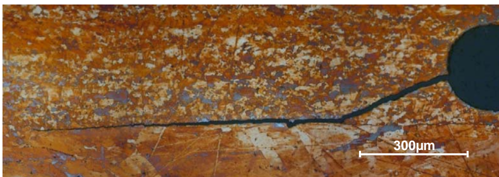
Abb. 4.16 Rechter Einriss von Probe 4-14
