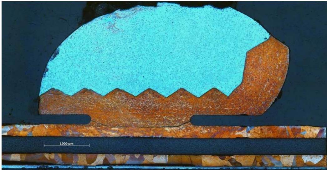
Abb. 4.14 Angerissene Probe 4-14 eines zeitlich beschränkten Ermüdungstests
