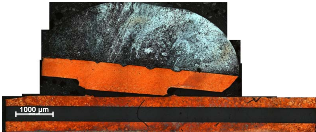
Abb. 4.13 Gebrochene Probe 2-19 im angeätzten Querschnitt
