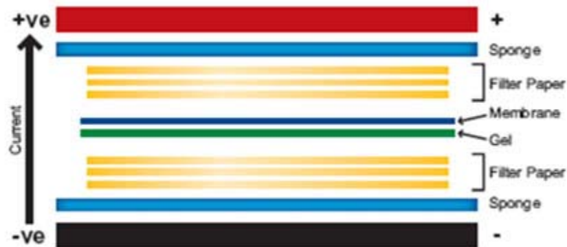
Abb. 16: Schema der Anordnung der einzelnen Bestandteile der Transferkassette.
