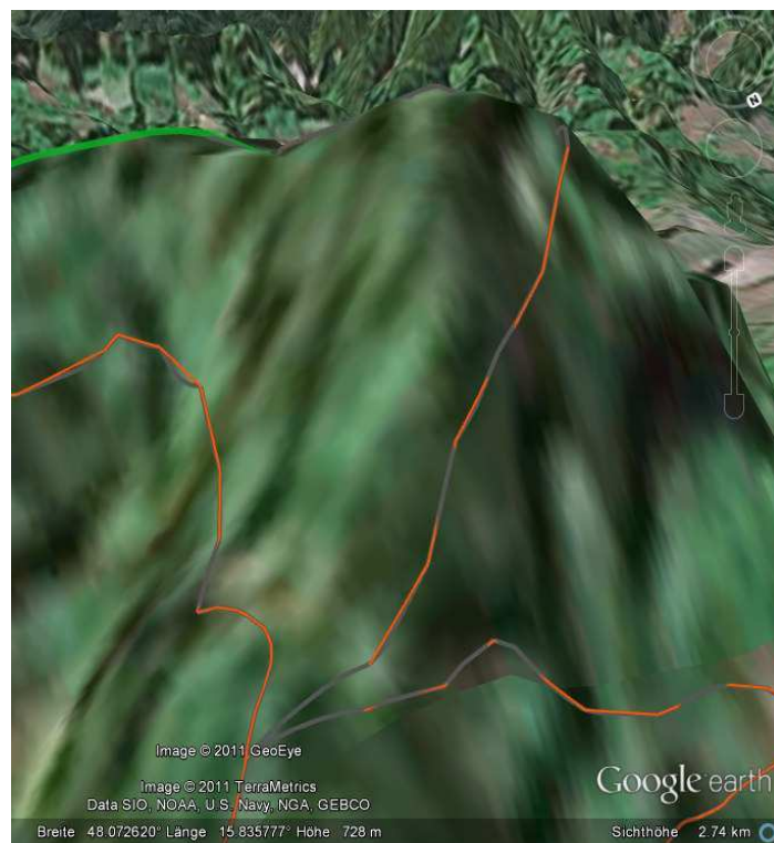
Abbildung 24 - Fehlerhafte Darstellung von linienartigen Objekten in Google Earth
