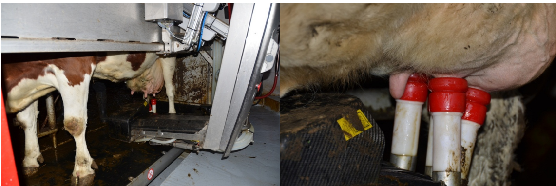
Abb. 15. & 16. Automatisches Ansetzen der Melkbecher mit Hilfe einer 3D-Kamera
