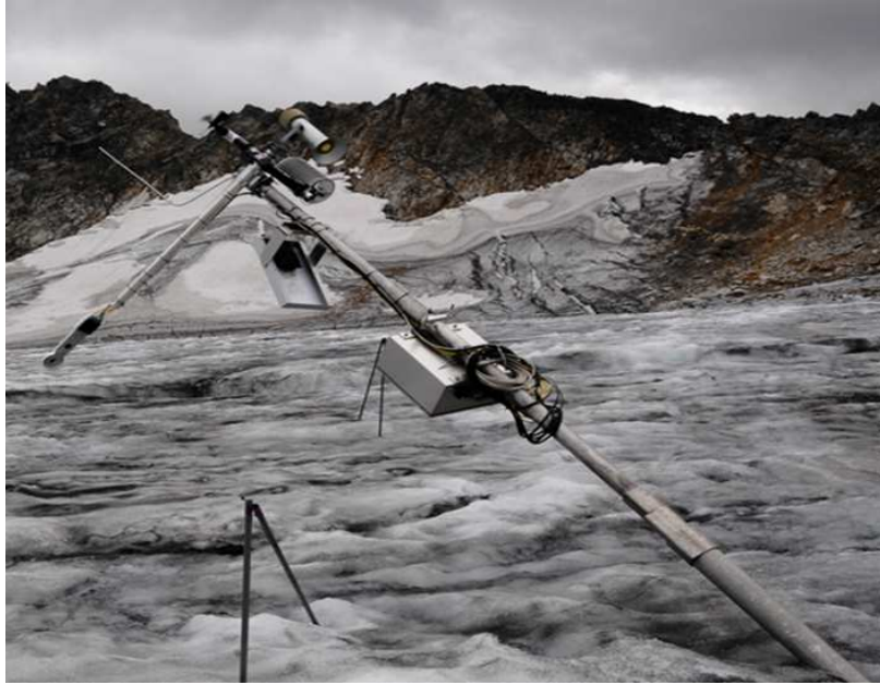
Abbildung 7.9: AWS auf dem Kleinfleißkees nach der Ausaperung im September 2011. Bei einer solchen Neigung sind die Messwerte nicht mehr verwendbar, Foto: Gernot Weyss.
