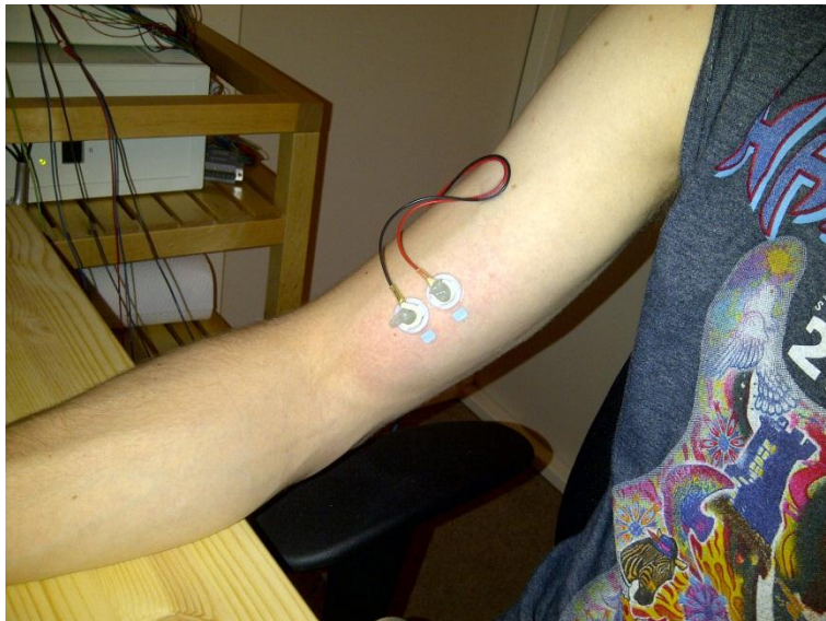
Abbildung 2: Zwei mit einem Interelektrodenabstand von 5 mm applizierte Elektroden zur bipolaren elektromyographischen Ableitung der Muskelanspannung im Biceps Brachii. Zu sehen ist auch das Elektrodengel in den Elektrodenringen, sowie die Zulentlastung der Elektrodenkabel mittels Tapematerial.
