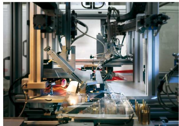
Abb. 9-11: Eine vollautomatische, computergesteuerte Klassierwaage, aktuell in Verwendung in der Münze Österreich.<sup>4</sup>
