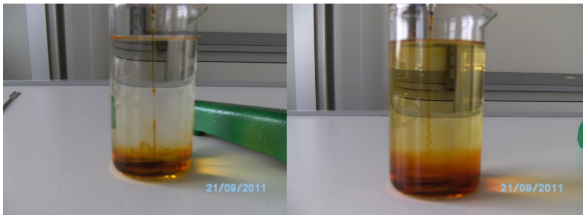
Abb. 4: Lösen von Jodkristallen mittels Kapillare in Ethanol
