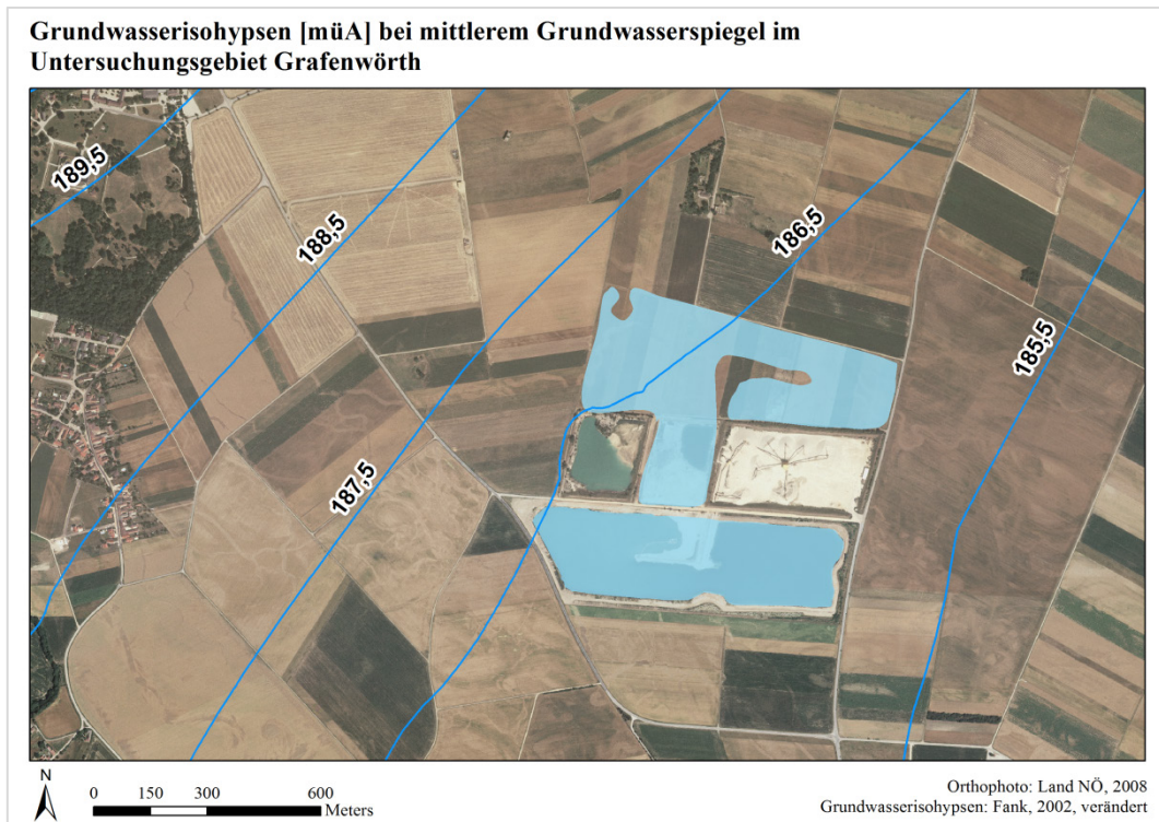
Abb. 5: Grundwasserisohypsen des Untersuchungsgebietes in Grafenwörth bei mittlerem Grundwasserspiegel (Stichtag: 01.06.1995)
