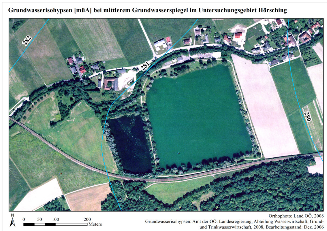
Abb. 8: Grundwasserisohypsen des Untersuchungsgebietes in Hörsching bei mittlerem Grundwasserspiegel
