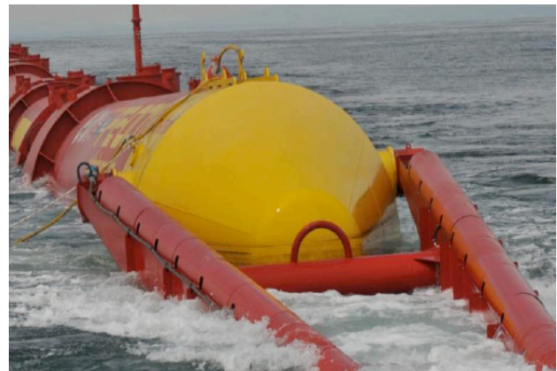
Bild 25: Schwimmkörper 750 kW an den Orkney Inseln (Großbritannien)
