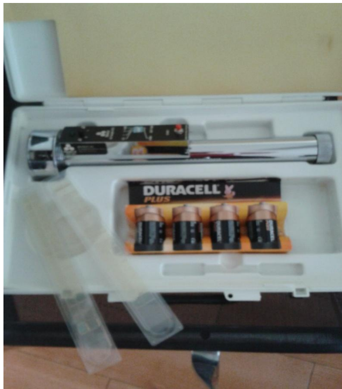
Abb. 15: HYCON Biotest Luftkeimsammler mit 2 Agarstreifen (Foto: Felix Bachmair)
