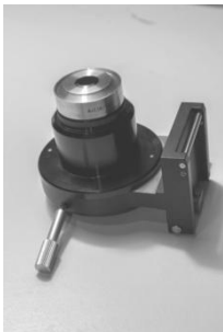
Abbildung 6 Ölkondensator für das Dunkelfeldverfahren
