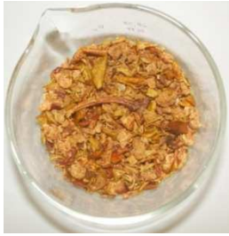
Abbildung 5: Apfeltrester der Firma „Rauch“ (ofengetrocknet, RO)
