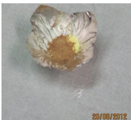
Abbildung 15: Probe in einer Zinnfolie mit Wolframpulver (eigene Aufnahme 2012)
