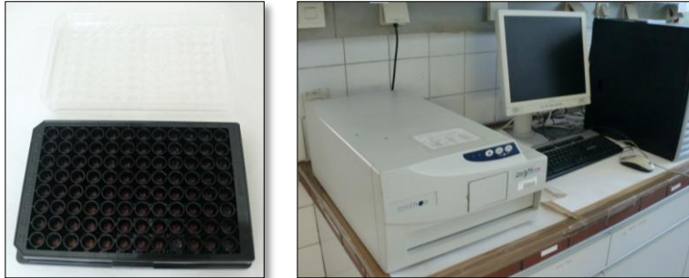
Abbildungen 18 und 19: Spezielle 96-Well-Mikrotiterplatte (schwarz mit transparentem Boden) für die LIP Messung, Anthos Zenyth 3100
