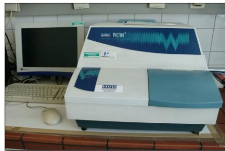
Abbildungen 15 und 16: Proteinbestimmung nach Bradford in Mikrotiterplatte, VICTOR 2 Photometer
