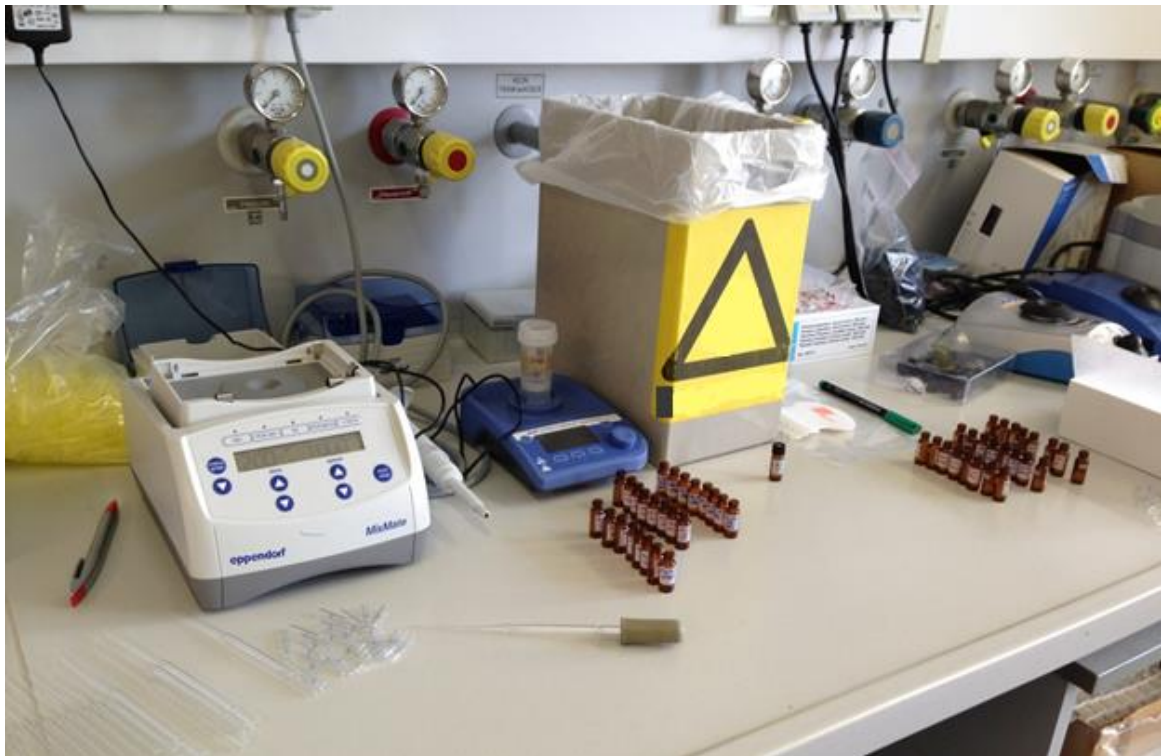
Abb. 15: Arbeitsplatz: Überführen des Überstands in Vials der HPLC-Braunglas Fläschchen mit Glaseinweg-Pipetten
