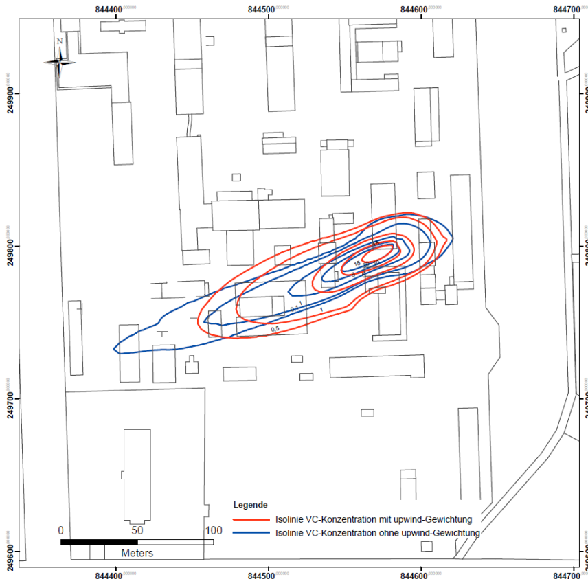
Abbildung 108: Einfluss der upwind-Gewichtung auf das Berechnungsergebnis (GW-Leiter 1-1)
