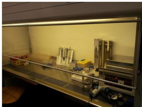
Abb. 45: Laminar-Flow Werkbank
