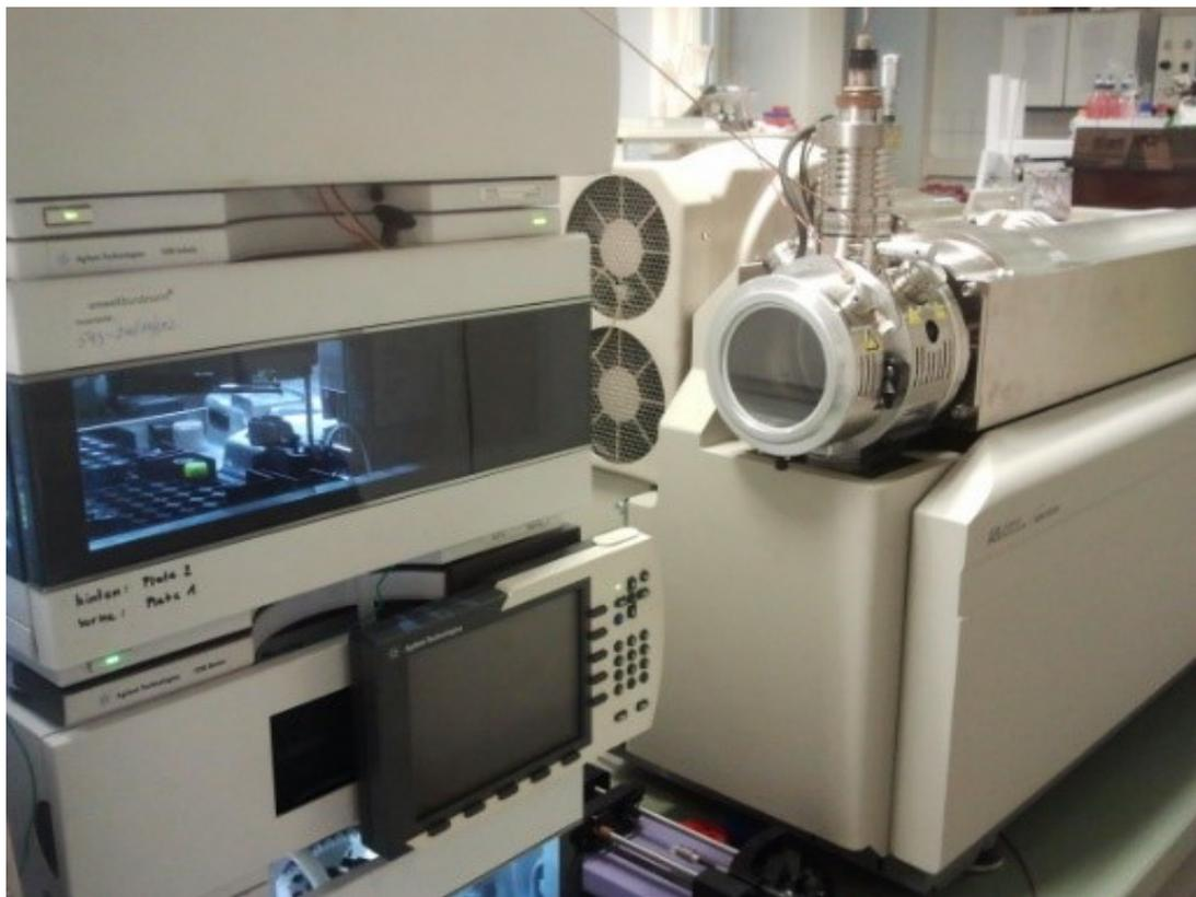
**Abb. 37: LC-MS/MS 3 & 4: LC Agilent 1290 Infinity Series gekoppelt mit einer AB SCIEX 4000 Q TRAP**
