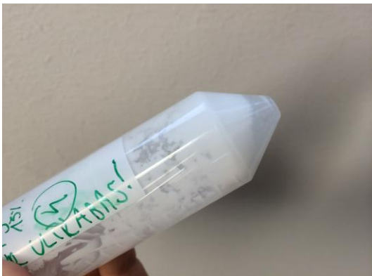
Abbildung 12: Phasentrennung in der Ultrabas Formulierung
