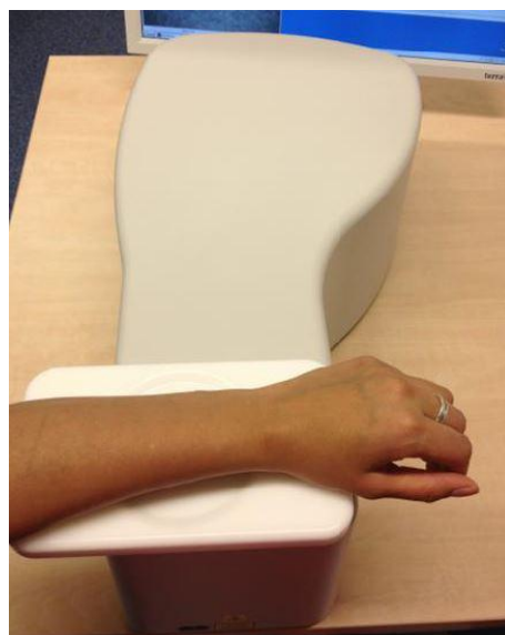
Abbildung 17: Positionierung Unterarm auf Objektiv des Raman-Spektrometers [36]
