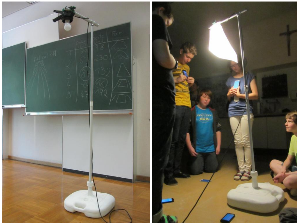
Abbildung 27: links: Ein beweglicher Leuchtkörper wird an einem Stativ befestigt und dient als Modell einer Straßenleuchte. rechts: Die Schüler und Schülerinnen befestigen ihre gebastelten Schirme an der Leuchte und messen die Helligkeit am Boden und an den Seiten.
