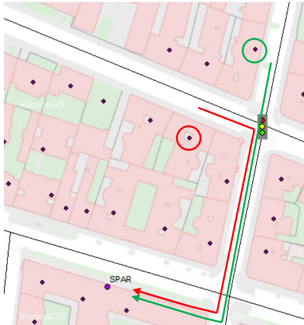
Abb. 38: Richtiger (grün) und falscher (rot) Einbezug der Verkehrslichtsignalanlagen als Impedanzen (ausgehend von zwei verschiedenen Adresspunkten) (Eigene Darstellung, 2015)
