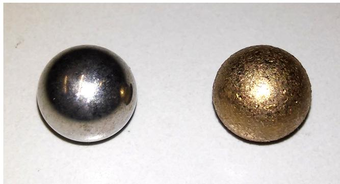
**Abbildung 4.7:** Probenvorbereitung: links eine Stahlkugel der Schwingmühle zu Beginn, rechts nach dem Mahlprozess; die Kugel ist von einer Schicht des Probenmaterials überzogen.
