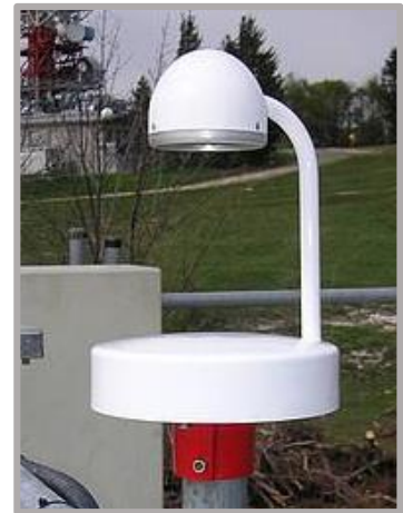
Abbildung 24: Feldmühle der Blitzforschungsstation am Gaisberg
