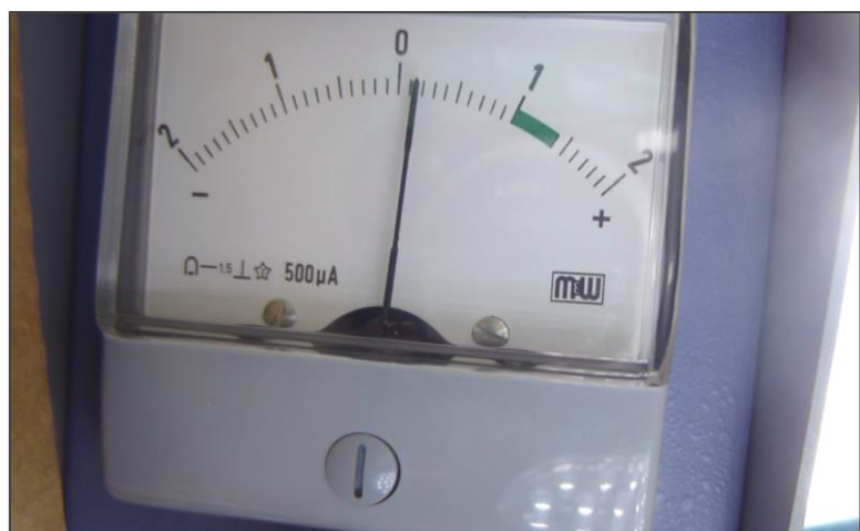
Abbildung 52: Messanzeige der elektrischen Feldmühle bei Schönwetter
