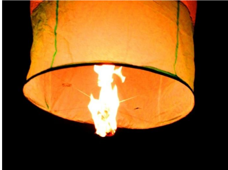
Abb. 6: Der Aufbau eines Aeróstatos – ein Metallreifen, der mit zwei Drähten stabilisiert wird, das brennende Tuch und auch die „Nähte“ an denen das Seidenpapier zusammen geklebt wurde sind auf dem Bild zu erkennen.
