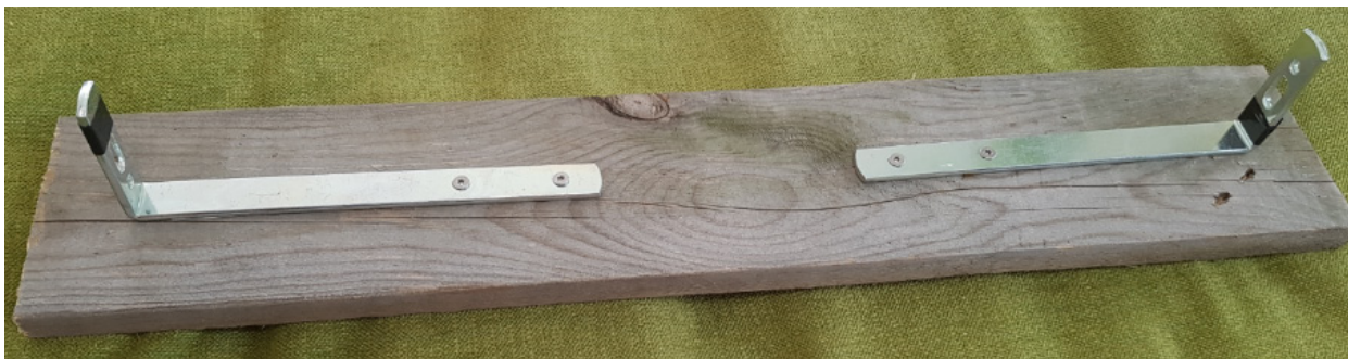
Abbildung 30: Selbst angefertigtes Diopterlineal
