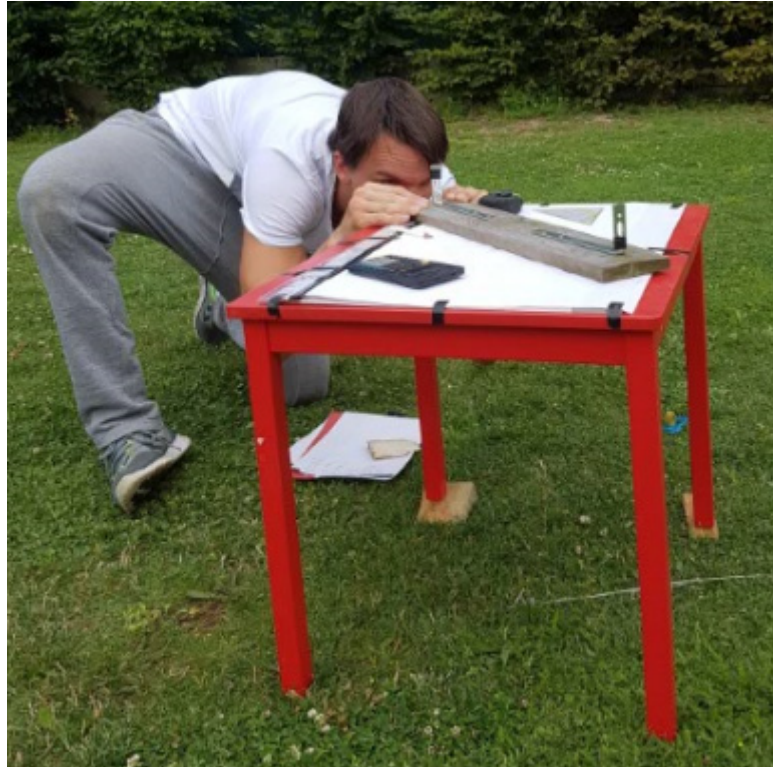
Abbildung 31: Anvisierung einer Signalstange durch das Dioptralineal
