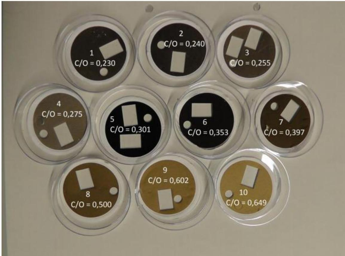
Abbildung 28 Foto von mit dem Ruß der zehn Einstellungen beladenen Filtern (Messreihe 16\_007). Die Löcher in den Filtern stammen von Stanzungen für die Ulbrichtkugel – Photometer (runde Löcher), bzw. Sunset Analyzer (rechteckige Löcher) Messungen. Man beachte, dass die Einstellungen 3, 4, 9 und 10 entsprechenden Filter relativ schwach beladen sind, im Vergleich zu den restlichen Filtern.
